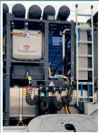
Depósito de óleo atrás da cabine num trator de 4 eixos
