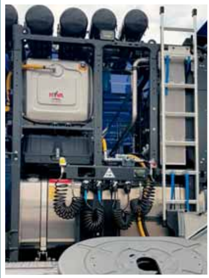
Réservoir d'huile derrière la cabine sur un tracteur à 4 essieux
